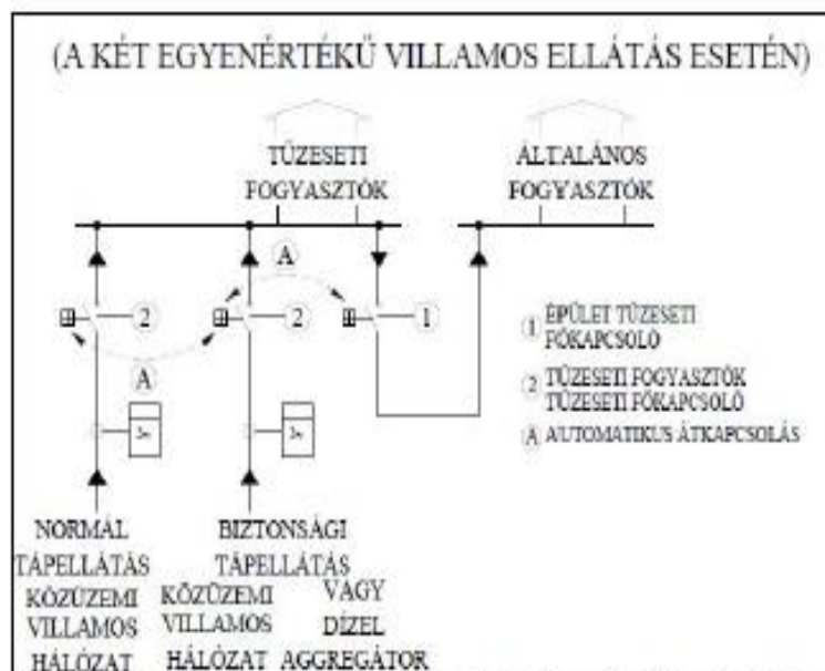
7. ábra Tüzeseti fogyasztók ellátás kettős biztonsági betáplálással „A”
